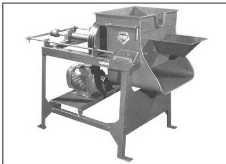
Se accionan con un motor eléctrico de 10 H.P., 1750 R.P.M., o su equivalente en motor de combustión interna de 16 H.P.
