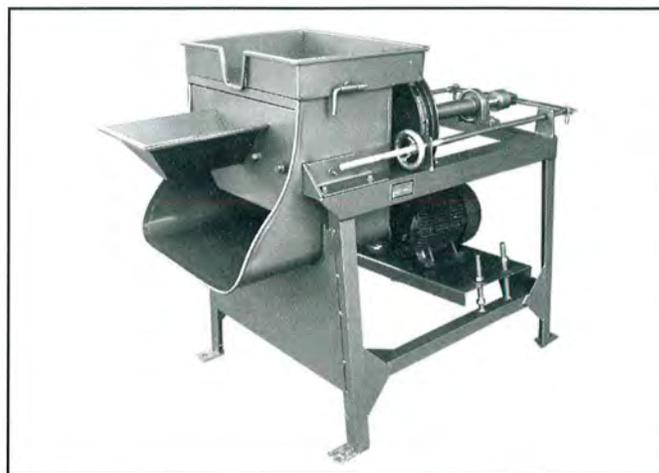
Se accionan con un motor eléctrico de 10 H.P., 1750 R.P.M., o su equivalente en motor de combustión interna de 16 H.P.
