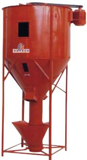
Mezcladora vertical con tolva giratoria para motor eléctrico
