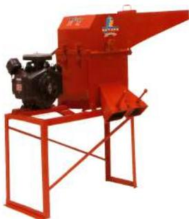
Molino con encostalador con base, polea y bandas para motor de combustión
