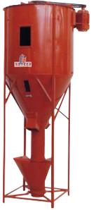
Mezcladora vertical con tolva giratoria para motor eléctrico
