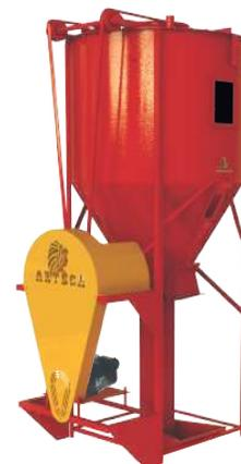
Mezcladora vertical con tolva a piso para motor a gasolina
