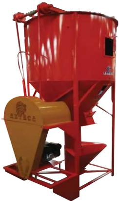
Mezcladora vertical con tolva giratoria para motor a gasolina
