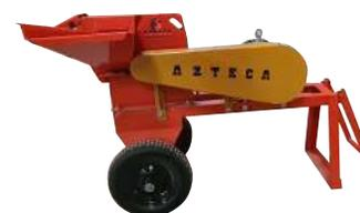
*Ensiladora de verdes y secos de 6 cuchillas, con remolque a motor eléctrico EVS-5*
