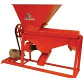
*Desgranadora en base, poleas y bandas para motor eléctrico*
