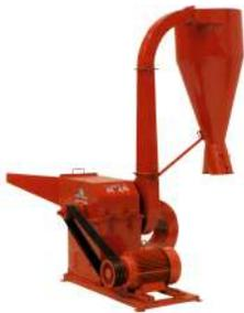
Molino con encostalador con base, polea y bandas para motor eléctrico.
