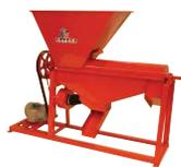
*Desgranadora en base, poleas y bandas para motor eléctrico*
