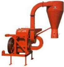
*Molino con ventilador y ciclón N°24 para toma de fuerza con levante hidráulico.*
