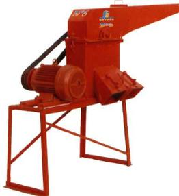
Molino con encostalador con base, polea y bandas para motor eléctrico.
