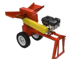
*Ensiladora de verdes y secos de 6 cuchillas, con remolque a motor a gasolina EVS-5*
