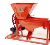
*Desgranadora en base, poleas y bandas para motor a gasolina*
