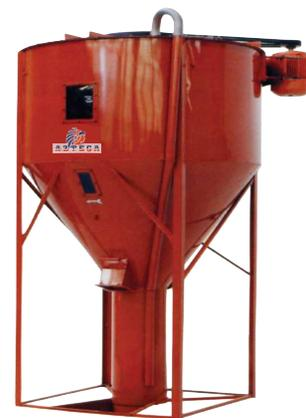
Mezcladora vertical con tolva a piso para motor eléctrico
