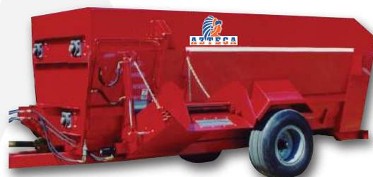
**Carro ensilador mezclador de forraje para ganado marca Azteca, modelo CMR 120 con capacidad Total de 3.50 ts<sup>3</sup>.**
