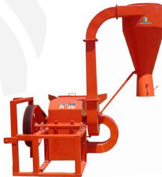
*Molino con ventilador y ciclón N°20 para toma de fuerza con levante hidráulico. NUEVO DISEÑO*
