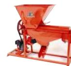
*Desgranadora en base, poleas y bandas para motor a gasolina*
