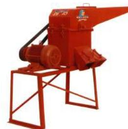
Molino con encostalador con base, polea y bandas para motor eléctrico.
